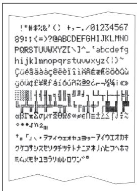
La RS-P42 è dotata di un self-test che stampa automaticamente i caratteri presenti sulla stampante.
