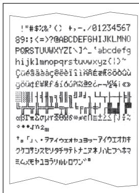
Der RS-P42 besitzt einen Selbst-Test, der automatisch den Zeichensatz des Druckers ausdrückt.
