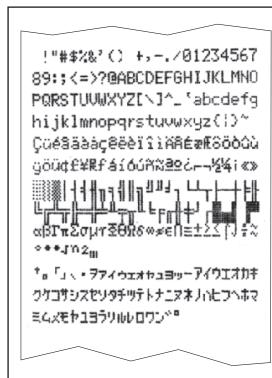
La impresora RS-P42 está equipada con una prueba de impresión que imprime automáticamente el carácter ajustado a la impresora.
